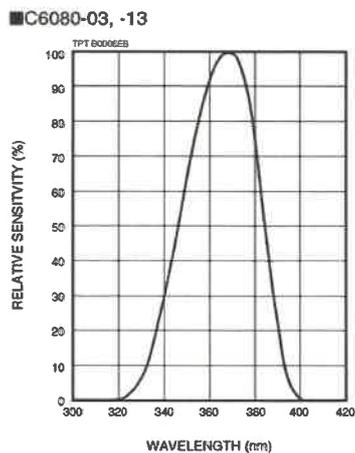
**Figura 3.** Sensibilidad del sensor del radiómetro empleado.
